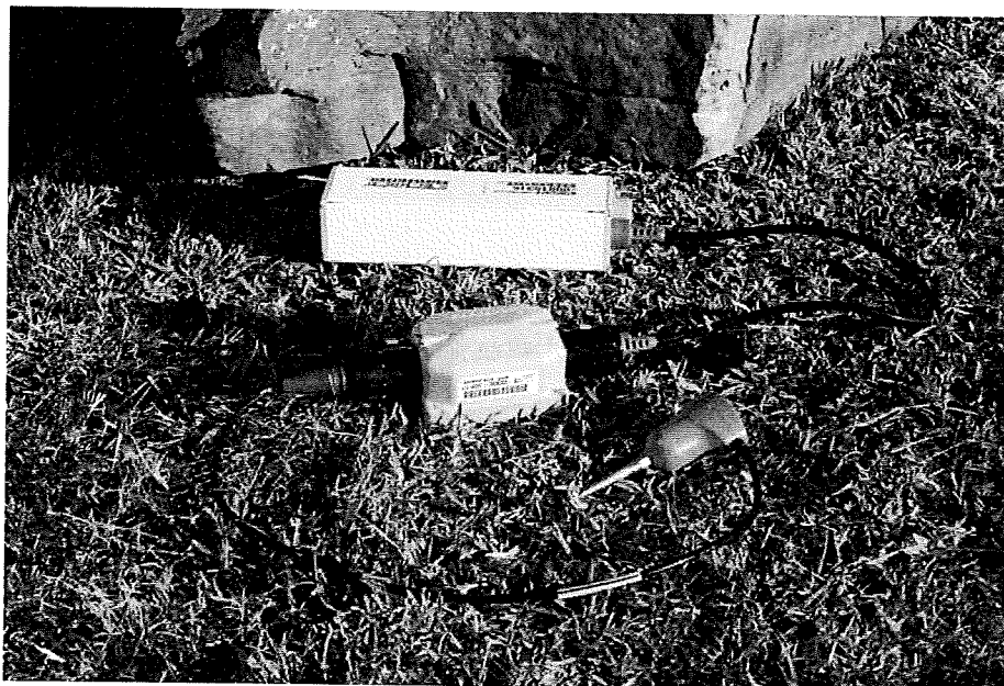
Kihelyezett terepi mérőpont, geofon és adatgyűjtő elektronika
